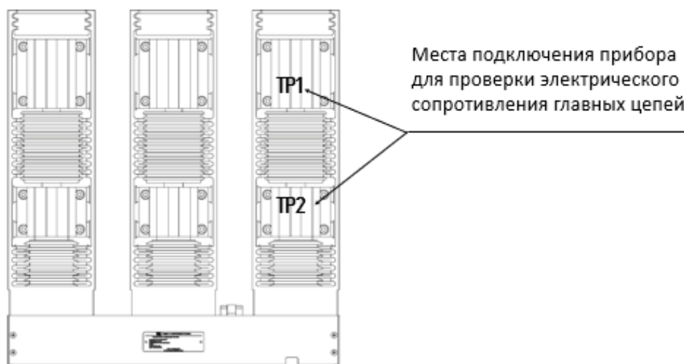
Рисунок 18 – Подключение к полюсам ВВ конструктивного исполнения 9 при проверке электрического сопротивления главных цепей полюсов ВВ
