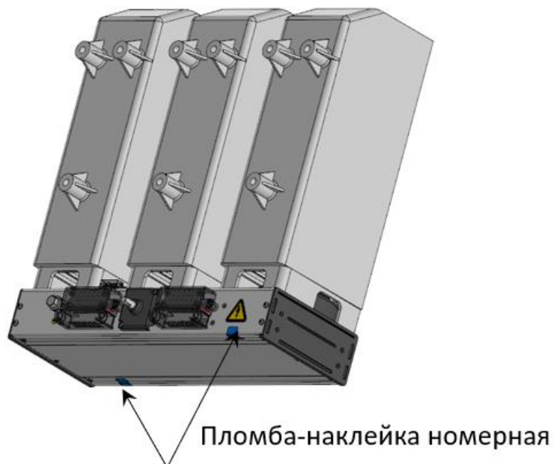
Рисунок Г.2 – Схема пломбирования ВВ с кодом конструктивного исполнения 9 ( I_{o,ном} до 31, 5 кА)
