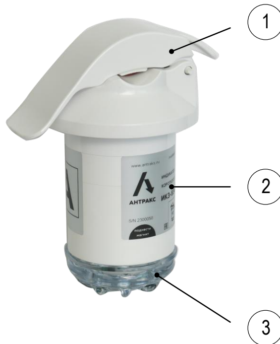
Рисунок 3.1 – Внешний вид ИКЗ-В54Л-Мастер: 1 – защелка для установки на провод, 2 – пластиковый корпус, 3 – прозрачная нижняя крышка
