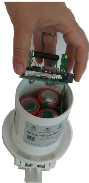
Рисунок 3.3 – Внешний вид ИКЗ-В52Л-Мастер. Плата индикации снята
