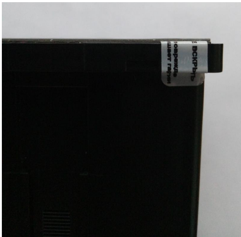
Рисунок 5.1 Место размещения гарантийной пломбы
