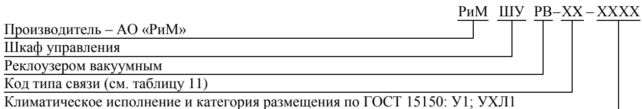
Рисунок 2.3 – Структура условного обозначения ШУ
