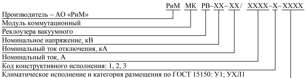
Рисунок 2.2 – Структура условного обозначения МК
