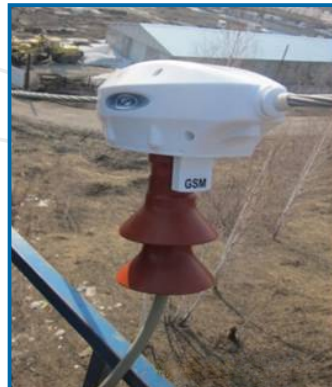
Общий вид ДИЭ измерителя (с внешним корпусом) установленного на ВЛ на фазе А,С
